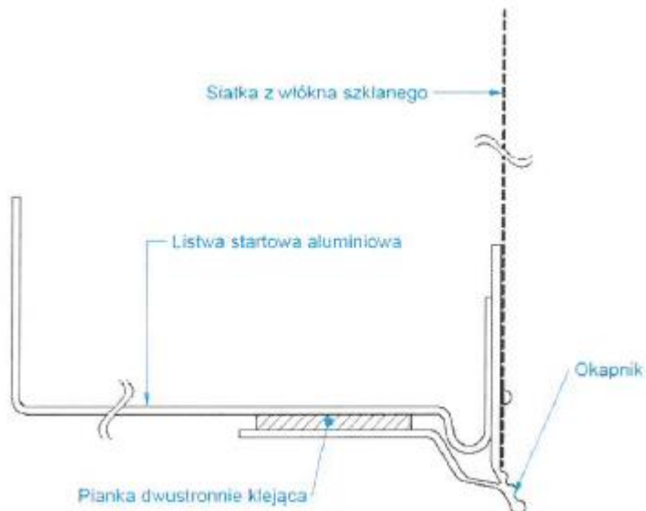
Fig. 2. Beads BP14 LUX (a), BP14 LUX N (b) and BP14 LUX COK Listwa startowa aluminiowa Aluminium starter strip Pianka dwustronnie klejąca Double-sided adhesive foam Okapnik Drip Siatka z włókna szklanego Fibreglass mesh
